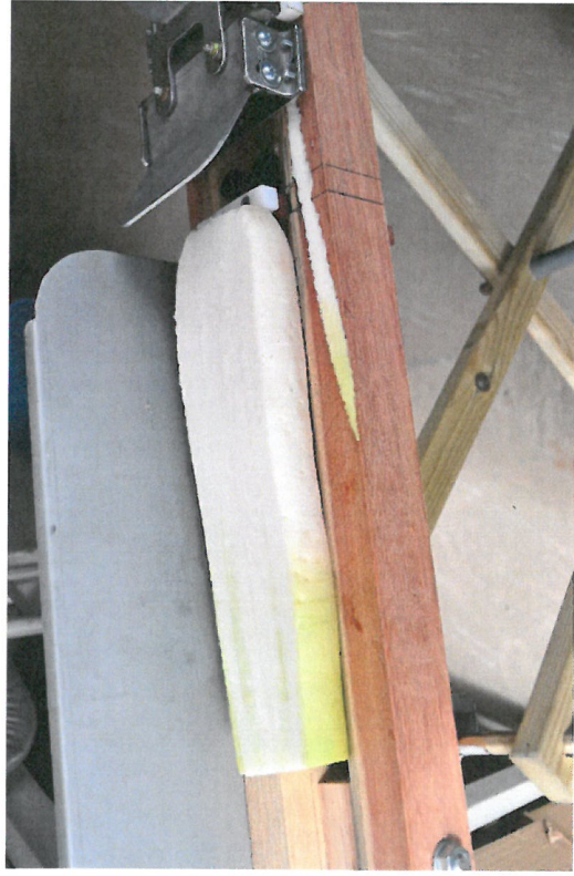
NO.8 切終平に切れているか確認して下さい 最後の部分外側に残った薄く切れている所 万能カッターで切り無駄の内容に利用して下さい。
